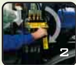
**2. Hydro Quick.** Keine unerfreulichen Überraschungen. Hydro Quick ermöglicht mit einem einzigen Handgriff das Ankoppeln aller hydraulischen Verbindungen an den Frontlader. Irrtümer sind ausgeschlossen, Ölverlust gehört der Vergangenheit an.
